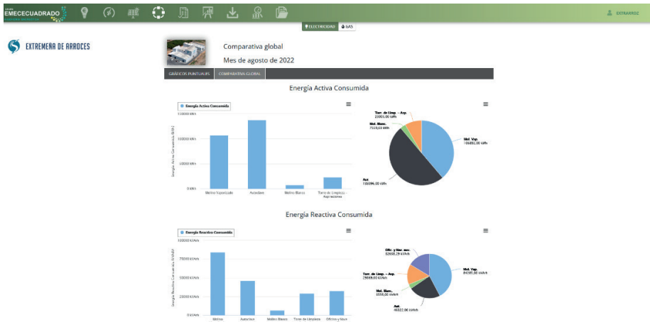
Imagen 2: Captura de la plataforma de Grupo Emececuadrado para el tratamiento los datos extraídos por los MentusH en Extremeña de Arroces.
