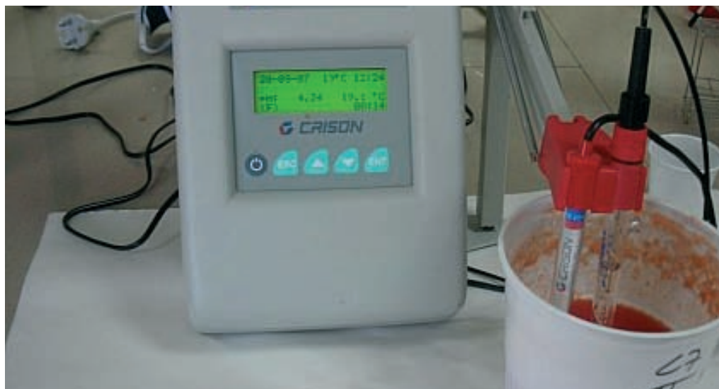
pHmetro midiendo una muestra de jugo de tomate
