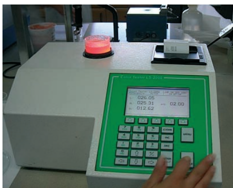
Colorímetro con muestra de jugo de tomate. Coordenadas de color.
