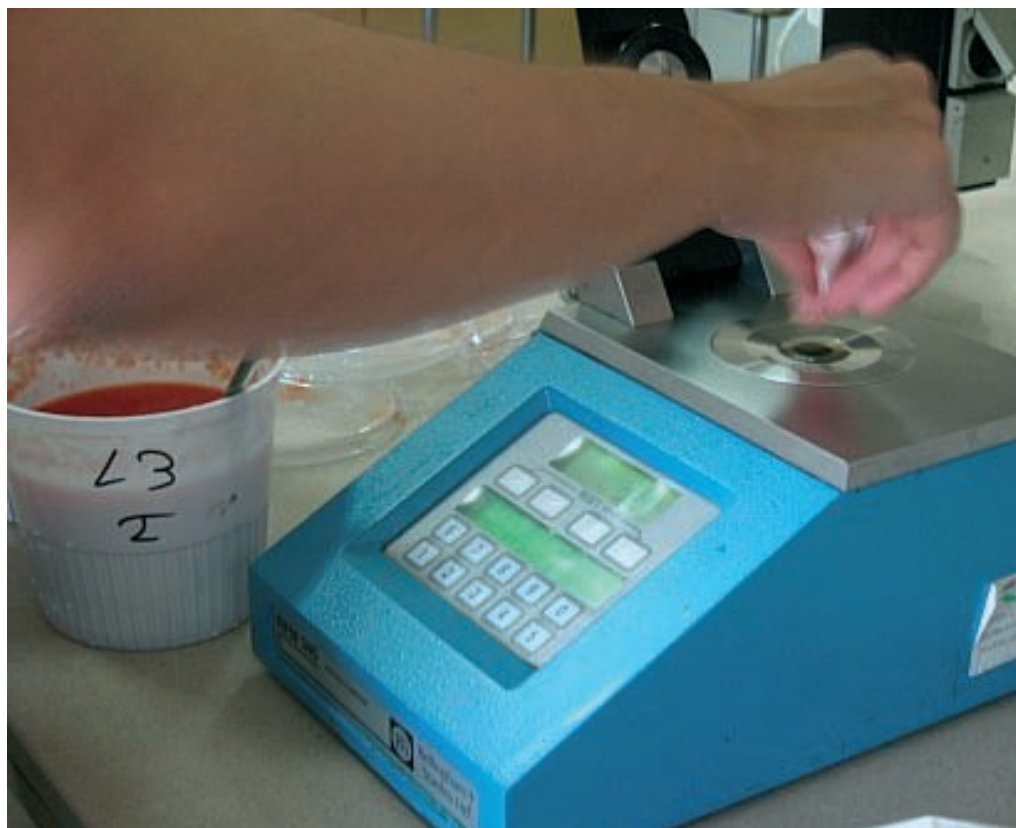
Refractómetro midiendo los ° Brix del jugo de tomate
