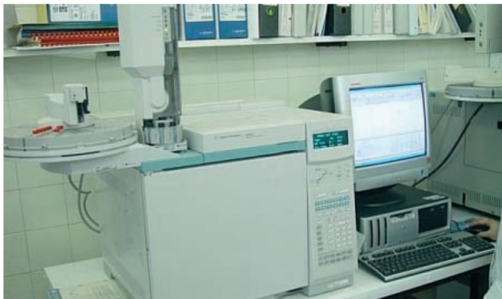
Cromatógrafo de gases para determinación de residuos de plaguicidas
