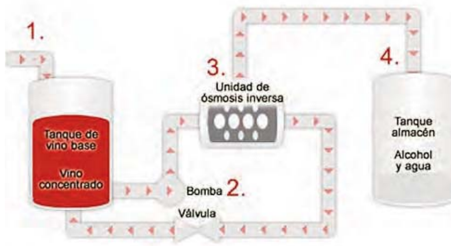
GRÁFICO 1: Esquema del proceso de desalcoholización mediante ósmosis inversa
