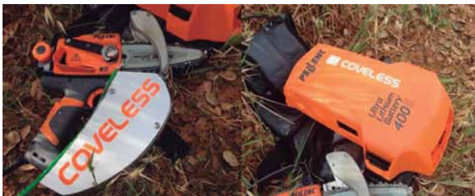
FOTO 4: Prototipo de la empresa COVELESS: a la izquierda la máquina de descorche, a la derecha la batería
