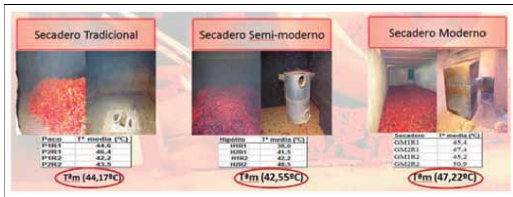
GRÁFICO 2: Tipos de secaderos y temperaturas medias del proceso de secado
