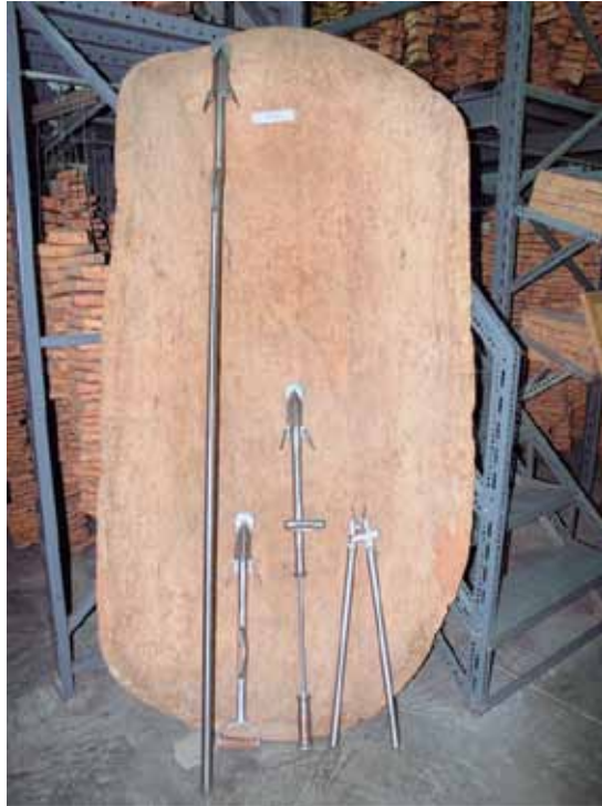
FOTO 5: Herramientas de descorche diseñadas por IPROCOR. De derecha a izquierda: tenazas corchera, mijuro percutor, mijuro corto y mijuro largo o de pértiga
