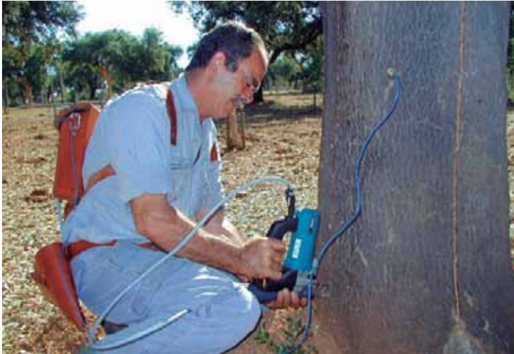
FOTO 2: Máquina IPLA durante el proceso de abrir
