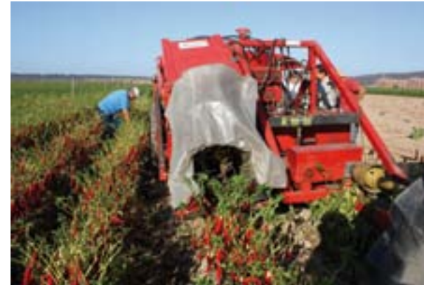
FOTO 4: Prototipo de cosechadora diseñado por Fabricaciones Vignolles y Automaquinaria Hermanos Alegre C. B. de Talayuela (Cáceres) en el campo de ensayo en La Vera
