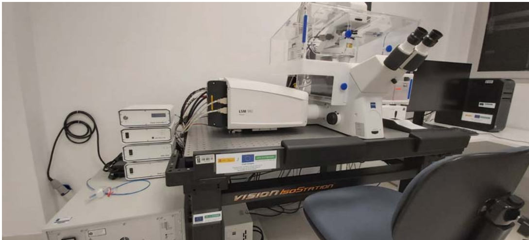
Figura 1. Microscopio confocal, con sistema de incubación de célula viva y mesa antivibratoria.
