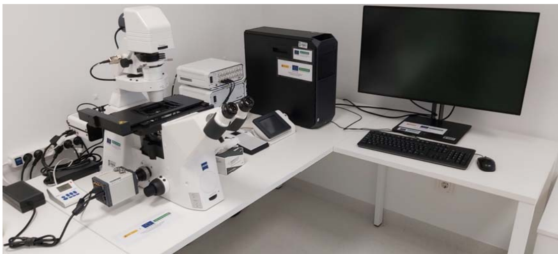
Figura 4. Línea pE-340 fura, sistema de iluminación CoolLED, para estudios de fluorescencia con Fura-2 en microscopio Axio Observer 3/5/7 KMAT.
