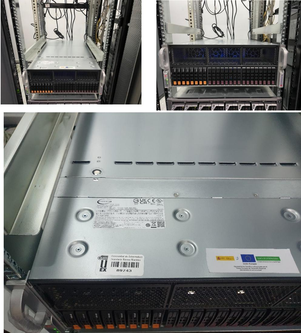
**Sistema de procesamiento gráfico dotado con almacenamiento masivo en red tipo rack**
