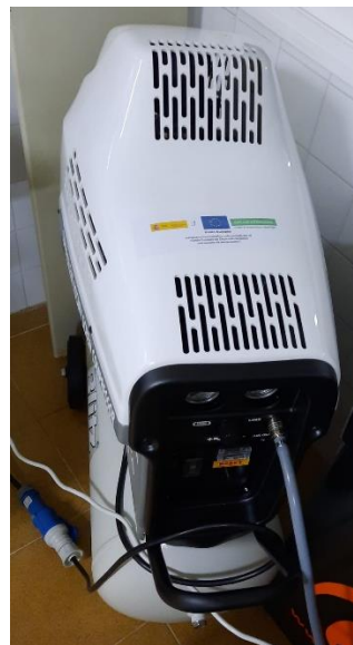
Fig. 2. Suministro de aire comprimido de la microfresadora LPKF protoláser S4.
