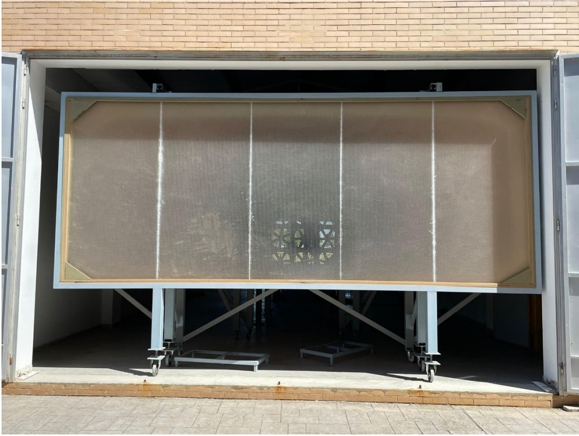
Fotografía 9. Honeycomb para la disminución de la turbulencia de entrada en el túnel.
