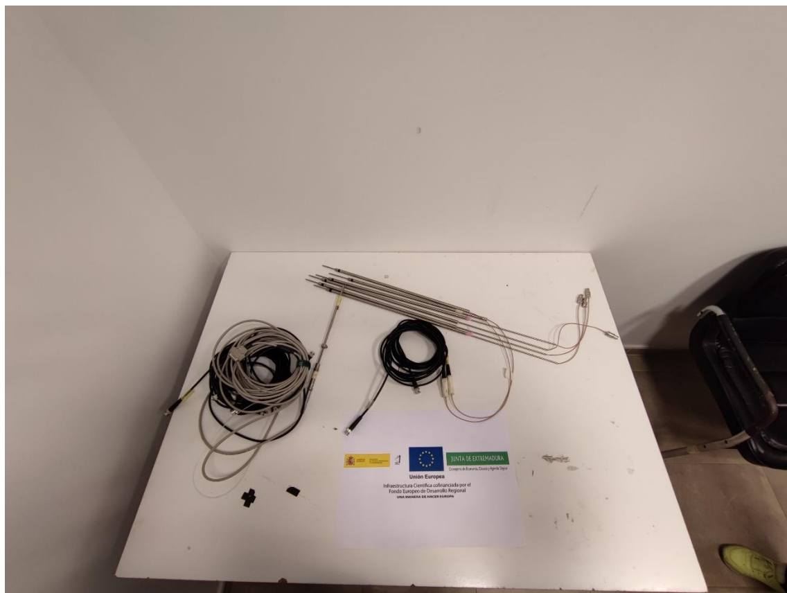
Fotografía 6. Sondas de anemometría de hilo caliente
