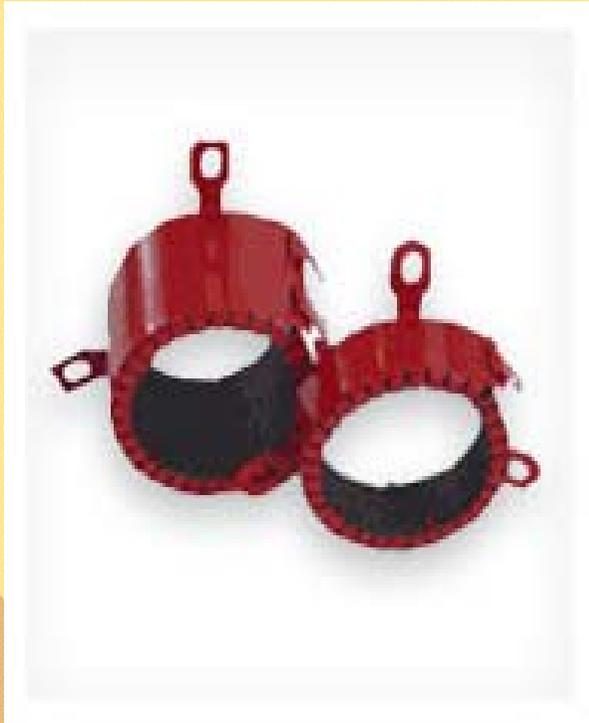
**Descripción del producto:** Está formado por un anillo metálico forrado con material intumescente que se monta alrededor del tubo, fijándose al muro o suelo mediante tornillos.
