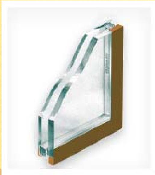
**Descripción del producto:** Vidrio laminado con gel intumescente en su interior especialmente diseñado para construir las particiones. Resistentes al fuego, de alta transparencia y luminosidad, con bordes afinados para permitir las juntas a testa que caracterizan el sistema.
